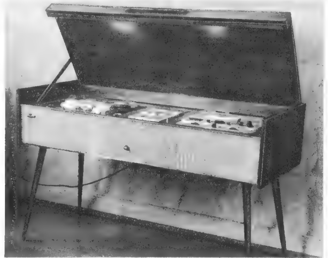
Bild 1. Ansicht der selbstgebauten Truhe für zwei Tonbandgeräte, ein Mischpult und verschiedene Zusatzeinrichtungen. Die Koffergeräte sind nicht fest eingebaut, so daß sie auch für Außenaufnahmen zu verwenden sind. (Will man die Truhe auch frei im Raum verwenden, um das Mikrophon in Blickrichtung zu haben, dann empfiehlt es sich, den Deckel abnehmbar zu machen)
